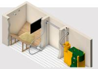
COCLEA DI TRASPORTO CON ALIMENTAZIONE TRAMITE ASPIRATORE
