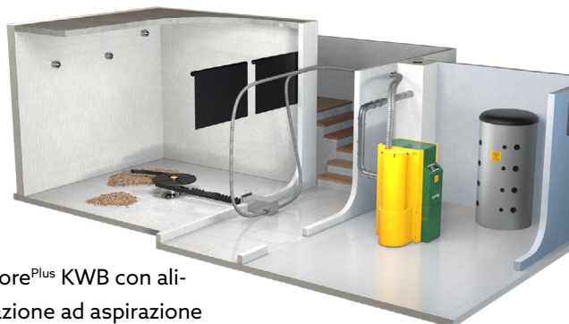
Deposito non adiacente al vano caldaia
