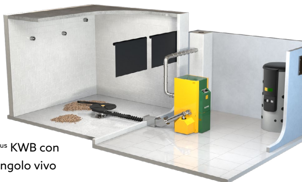
Deposito asciutto direttamente accanto al vano caldaia
