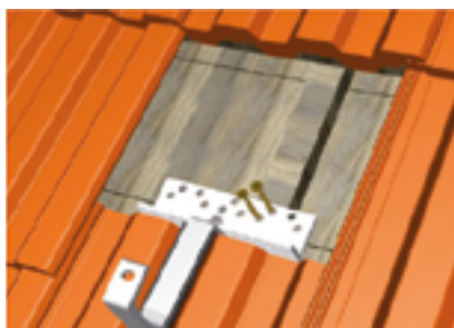
Montage des étriers de toit (DB 0°)
